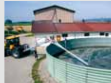
Podaljšek okvirja mešala za uporabo pri gnojničnih jamah višine do 3 m nad tlemi
