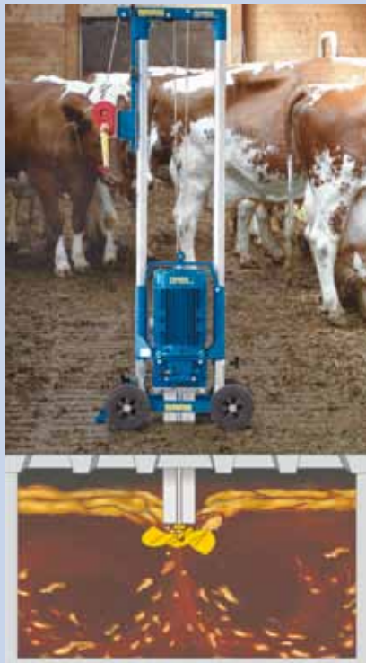
Zložljiv propeler ustvari agresivni tok mešanja
