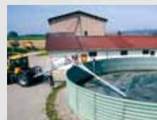
Podaljšek okvirja mešala za uporabo pri gnojničnih jamah višine do 3 m nad tlemi
