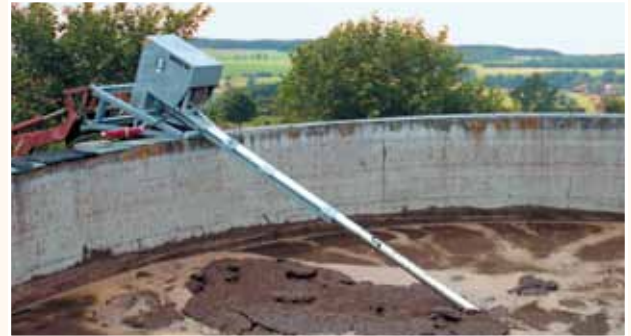
Priklop na prednji traktorski nakladač je še posebej priporočljiv v primerih, ko je potrebno mešalo pripeljati do gnojničnega bazena s traktorjem ali nakladačem.
