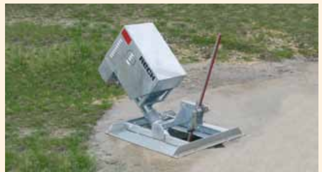
RECK elektro gnojnično mešalo s stacionarno namestitvijo za zaprte gnojnične jame. Nastavitev nagiba je izvedena s pomočjo navojne palice.
