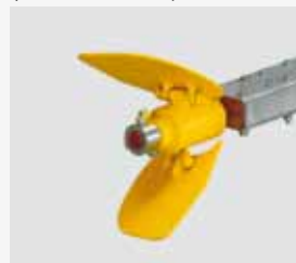
Dvokrilni zložljivi propeler (za odprtine nad 250 mm, na voljo le v tlačni izvedbi, razprt premer 500 mm Ø)
