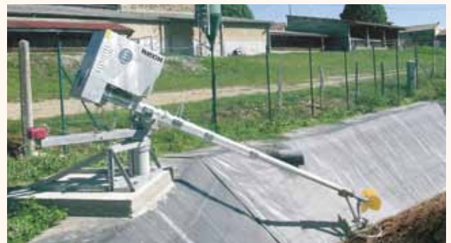
Prikazana stacionarna namestitev je še posebej primerna za velike zalogovnike gnojevke, kot so lagune.
