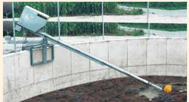
Prikazana stacionarna namestitev je še posebej primerna za odprte gnojnične bazene. Nastavitev po višini je izvedena brezstopenjsko. Mešalo se lahko zasuka za 360 stopinj.
